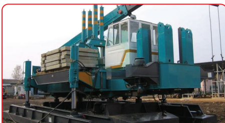
Máy ép cọc
